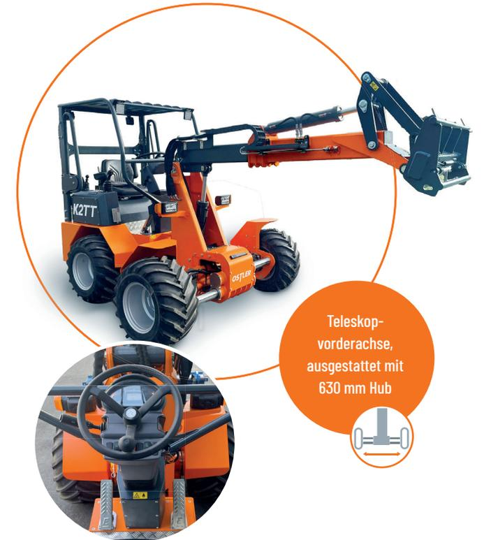
Teleskop-vorderachse, ausgestattet mit 630 mm Hub
