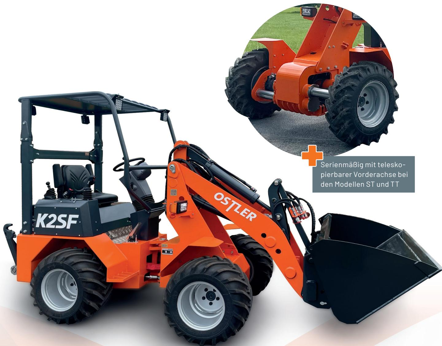
Serienmäßig mit teleskopierbarer Vorderachse bei den Modellen ST und TT
