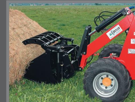
Durch DGS-Euronorm-Aufnahme kann handelsübliches Werkzeug verwendet werden.
